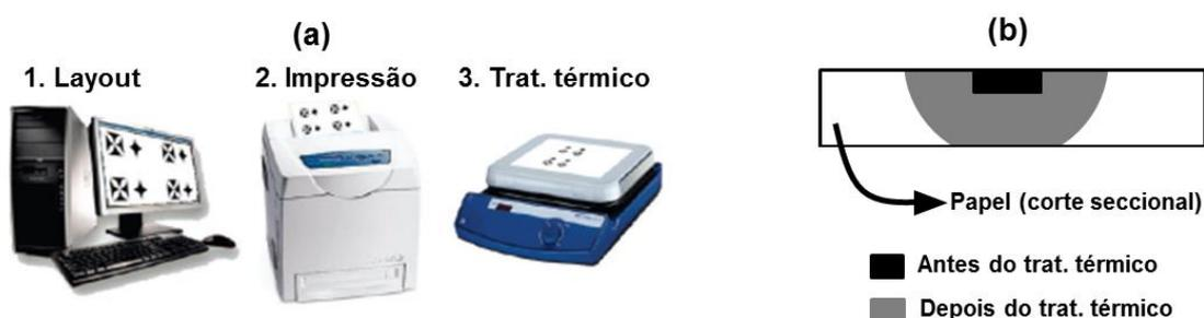
**Figura I.** (a) Etapas envolvidas no processo de construção. (b) Desenho estudado. (b) Esquema ilustrativo que mostra o espalhamento da cera pelo papel após o tratamento térmico. Figura adaptada [2].
