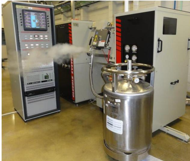
Figura 2: Simulador termomecânico Gleeble 3800® com módulo de torção e sistema de resfriamento com nitrogênio líquido.
