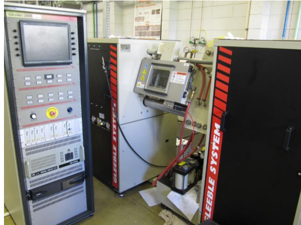
Figura 1: Sistema de ensaios termomecânicos Gleeble 3800®
