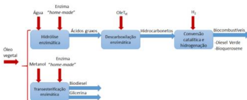
Figura 1- Rota proposta para síntese enzimática de biodiesel, diesel verde e bioquerosene.
