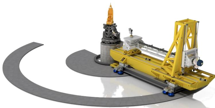
Figura 3: representação do espectrômetro RIXS da linha IPE do Sirius.
