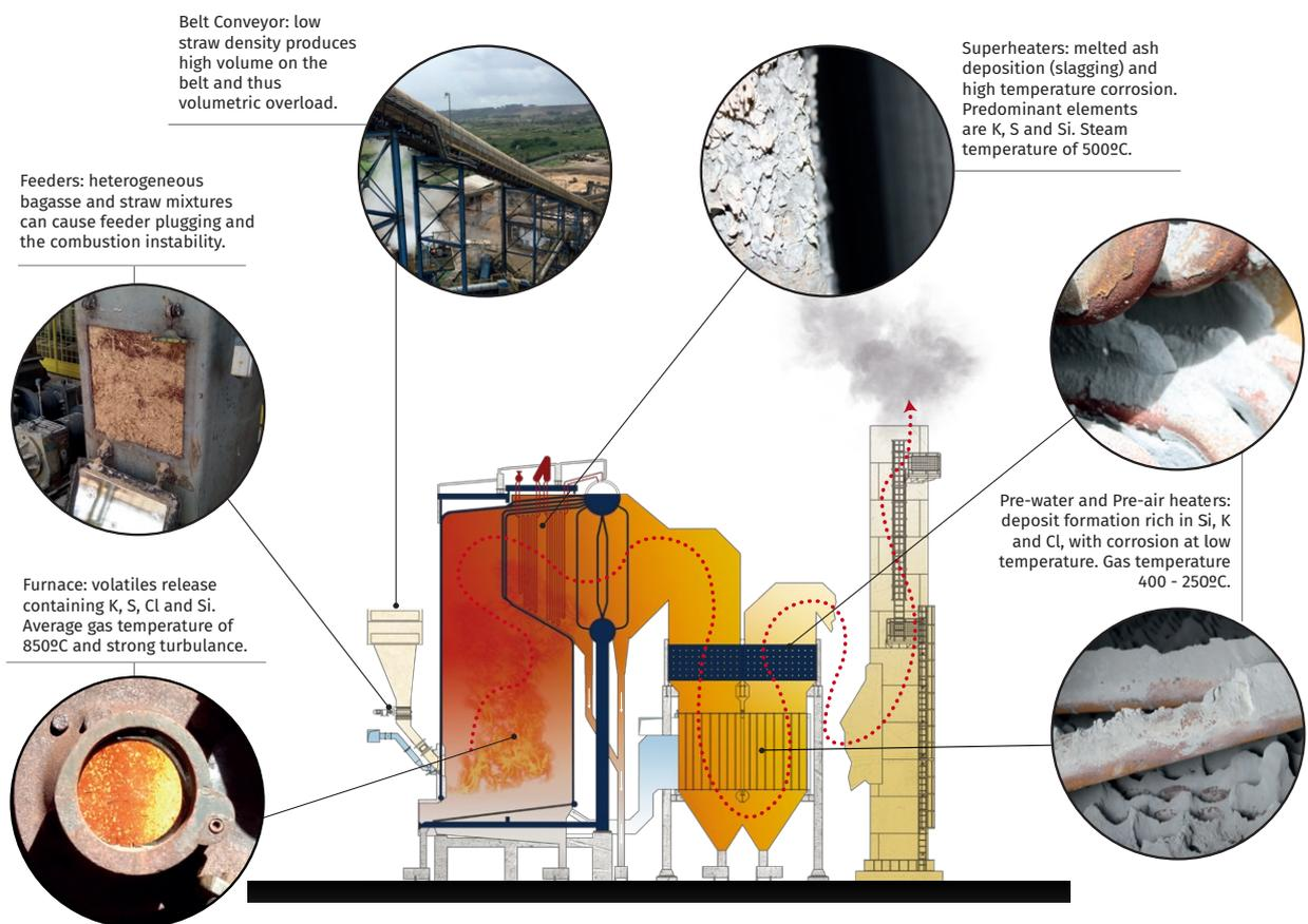
**Figure 62:** Burning straw impacts on the biomass boiler | Design credit: Luiz Nascimento/Comunicação CNPEM.
